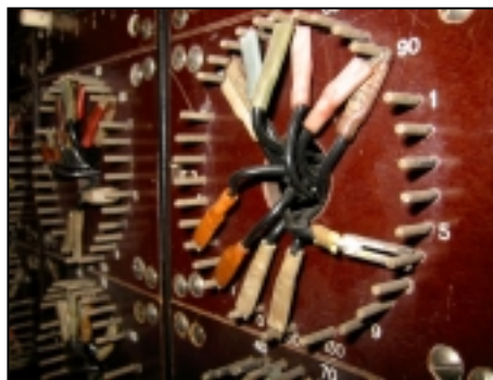
Fig. 1 Innstillingspanel på elektromekanisk rele
